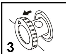
Gire las tapas de drenaje exteriores hasta que las flechas apunten hacia abajo. Asegúrese de que los desagües o las bandejas estén colocados debajo de los orificios para recoger el agua. Deje los equipos en reposo con las tapas abiertas mientras se descongelen o drenan. Revise regularmente para evitar desbordes de agua.
