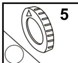
Vuelva a colocar las cubiertas en los desagües interiores. Ajuste la perilla a **[MÁX CONGELACIÓN]** durante 2 horas antes de restablecer la temperatura deseada.
