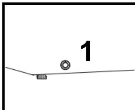
Los desagües interiores están ubicados en los pisos de los gabinetes. Retire las tapas de los desagües. El agua descongelada o condensada fluirá hacia los orificios y saldrá a través de las tapas de drenaje exteriores.
