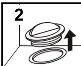
Las tapas de drenaje exteriores están ubicadas en la parte delantera de los gabinetes. Sáquelas suavemente entre 20 y 25 mm, hasta que los orificios de agua sean visibles.
